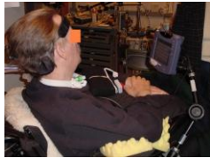
UI-ADL Charge Transfer Switch controls AAC device in Scan Mode for ALS Patient
